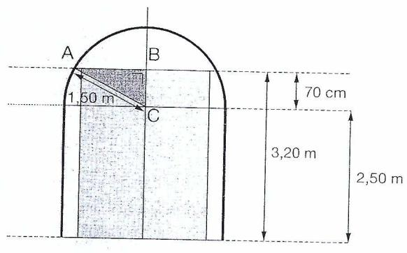
Détermination de la largeur du pont à une hauteur de 3,20 m
