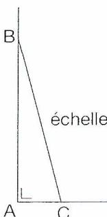
$$\text{a) } |BC| = 10 \text{ m} \Rightarrow |AC| = 2,5 \text{ m}$$
